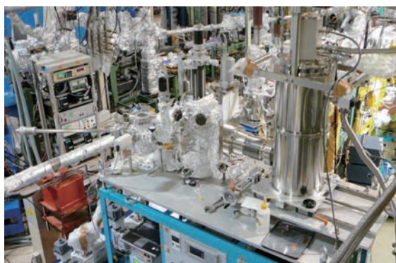
図1 超伝導検出器を用いた軟X線領域の蛍光収量法によるX線吸収分光装置
