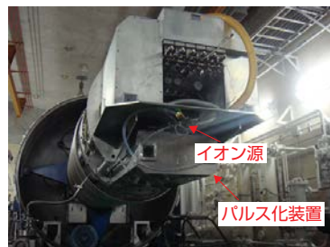
図2 産総研4 MVペレットロン加速器に導入されたイオンビームパルス化装置
