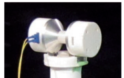
図 開発したEMI測定電波暗室評価システムの概念図と開発したアンテナの写真
