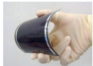
図2 ステンレス基板上の集積型フレキシブルCIGS太陽電池サブモジュール (10 cm×10 cm)
