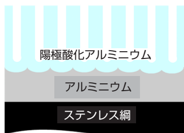
図1 今回のCIGS太陽電池で利用したフレキシブル基板の断面模式図
