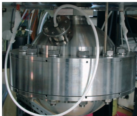
球型キャビティによる音波共鳴測定装置 気体の音速を高精度に計測することができる
