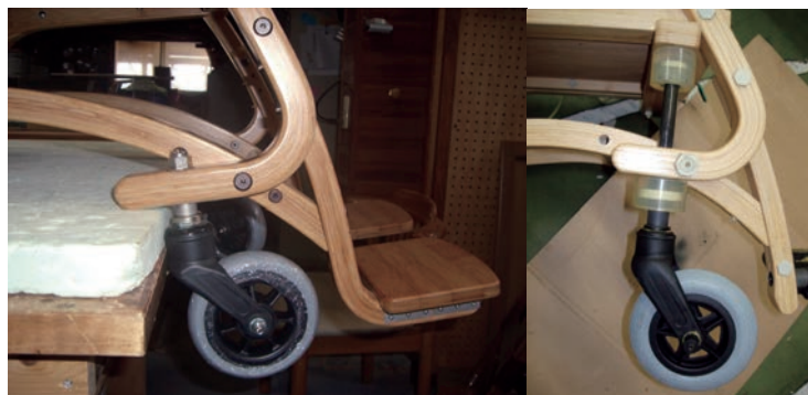
図1 ベースとなった1点支持型キャスター(左)と、開発した2点支持型キャスター(右)
