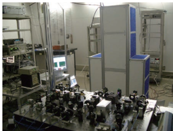
図 原子泉方式一次周波数標準器 (NMIJ-F1)
