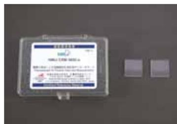
図3 超微細空孔測定用認証標準物質 (NMIJ CRM 5602a)
