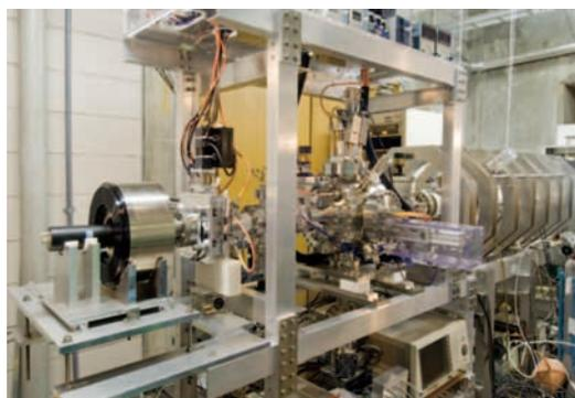
図1 陽電子プローブマイクロアナライザー
