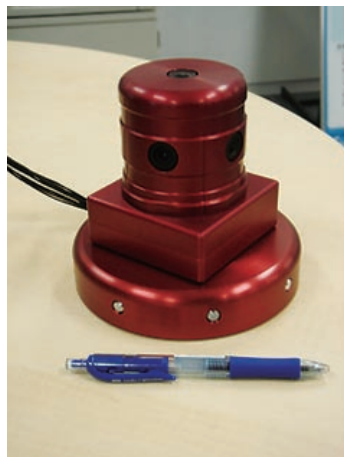
図1 全方位カメラとマイクロホンアレイからなる収録装置
