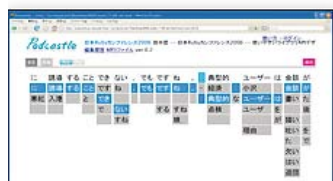
図2 音声認識の誤認識をユーザーが簡単に訂正できるインターフェースの画面例
