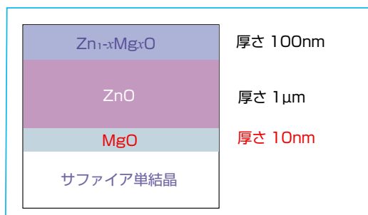
作製した試料の断面構造の模式図
