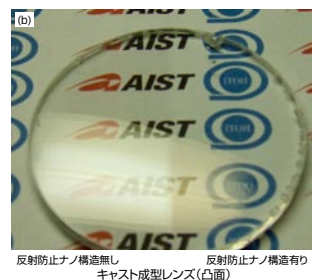
写真2 射出成形法により成型品を作製した例 (a) 平面金型の射出成形品 (b) レンズ金型の射出成形品
