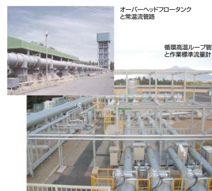
図4 大流量で世界最高精度の試験設備
