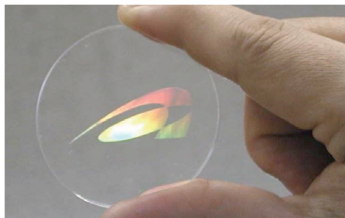
図1 LIBWE法による大面積加工の一例(基板5cmφ) 着色して見えるのは透過型回折格子からの散乱光の干渉現象。
