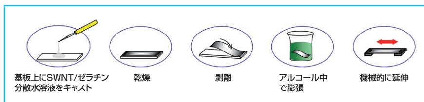
図1 ナノチューブをゼラチンの中に分散して配向膜を作る手順
