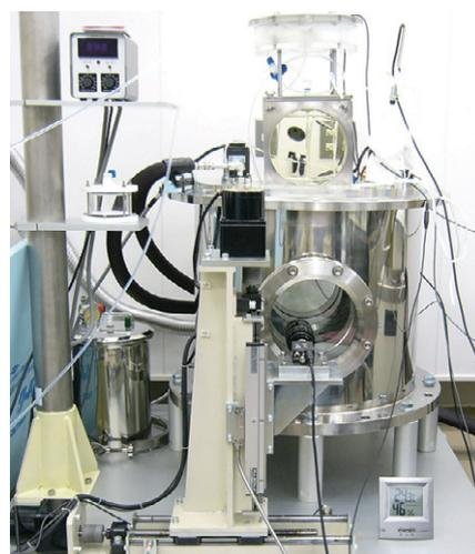
図3 圧力浮遊装置
