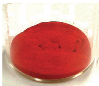
図1 高い二光子吸収感度を示すジアセチレン化合物とその構造式
