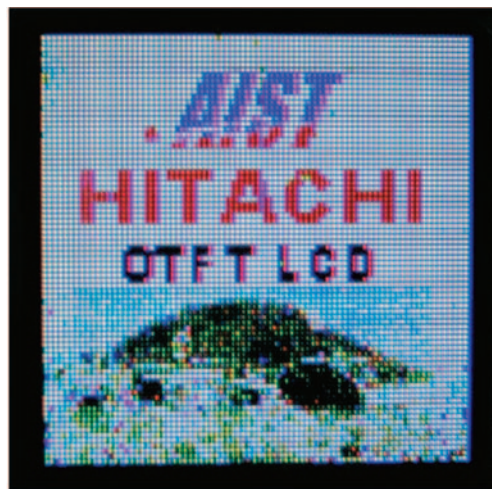
図1 有機TFT駆動カラー液晶表示パネル 対角画面サイズ1.4インチ、画素サイズ318 μm × 106 μm、画素数80 × 80 (RGB)、精細度80ppi
