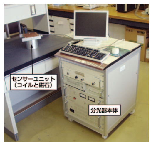
図 2 現在開発中の NMR 物理探査装置
