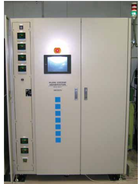
写真 超高濃度オゾン連続発生装置 Continuous 100% ozon generator
