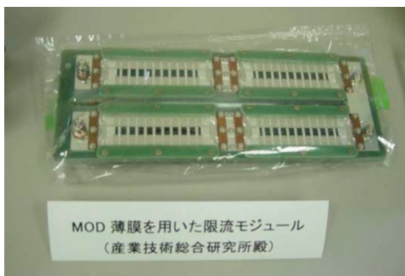
写真3 12cm×1cmサイズ超電導膜を組み込んだ4直列限流モジュール
