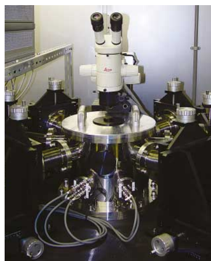
●写真 カーボンナノチューブ単一電子トランジスタ計測装置
