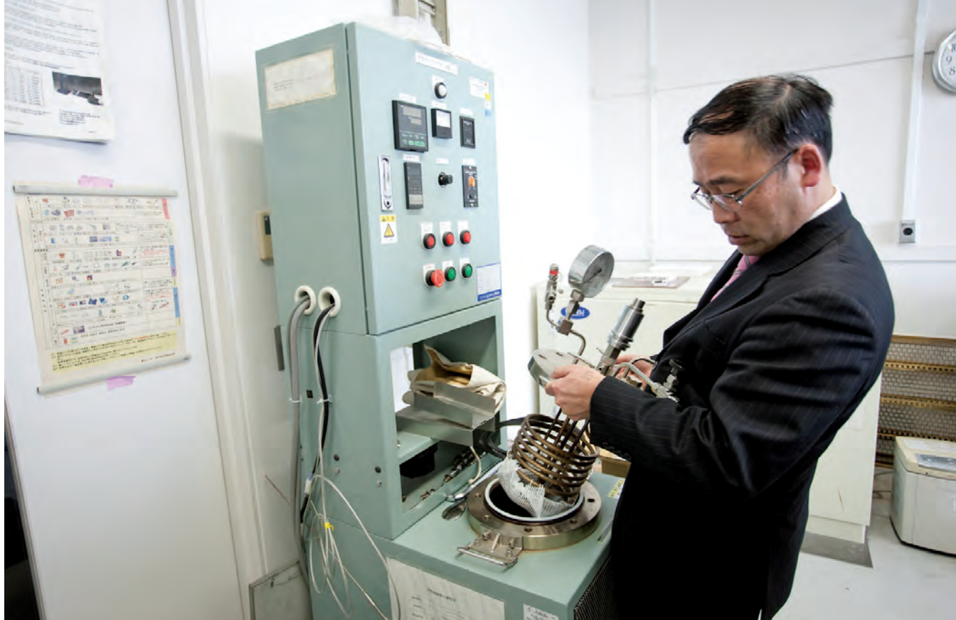
▲粘土を合成して製造する。透明な膜をつくるには、圧力釜で合成した人工粘土を用いる。
