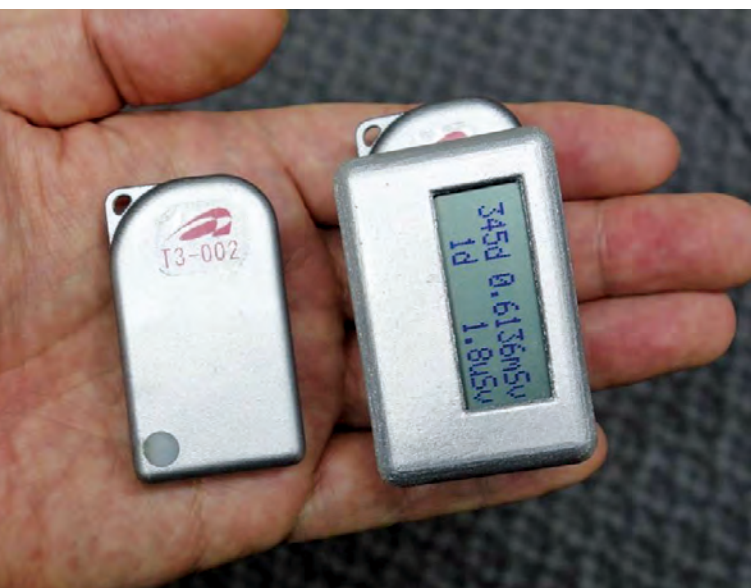
1年以上電池交換なしに使用できる小型線量計（左）とその表示器（右）。ポケットはもちろん、児童の名札ケースにも入る。
