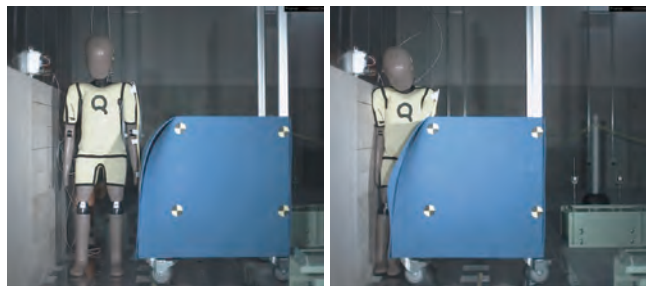
▲衝突安全性試験。ロボットが人と衝突してしまった場合の安全性を確認する。
