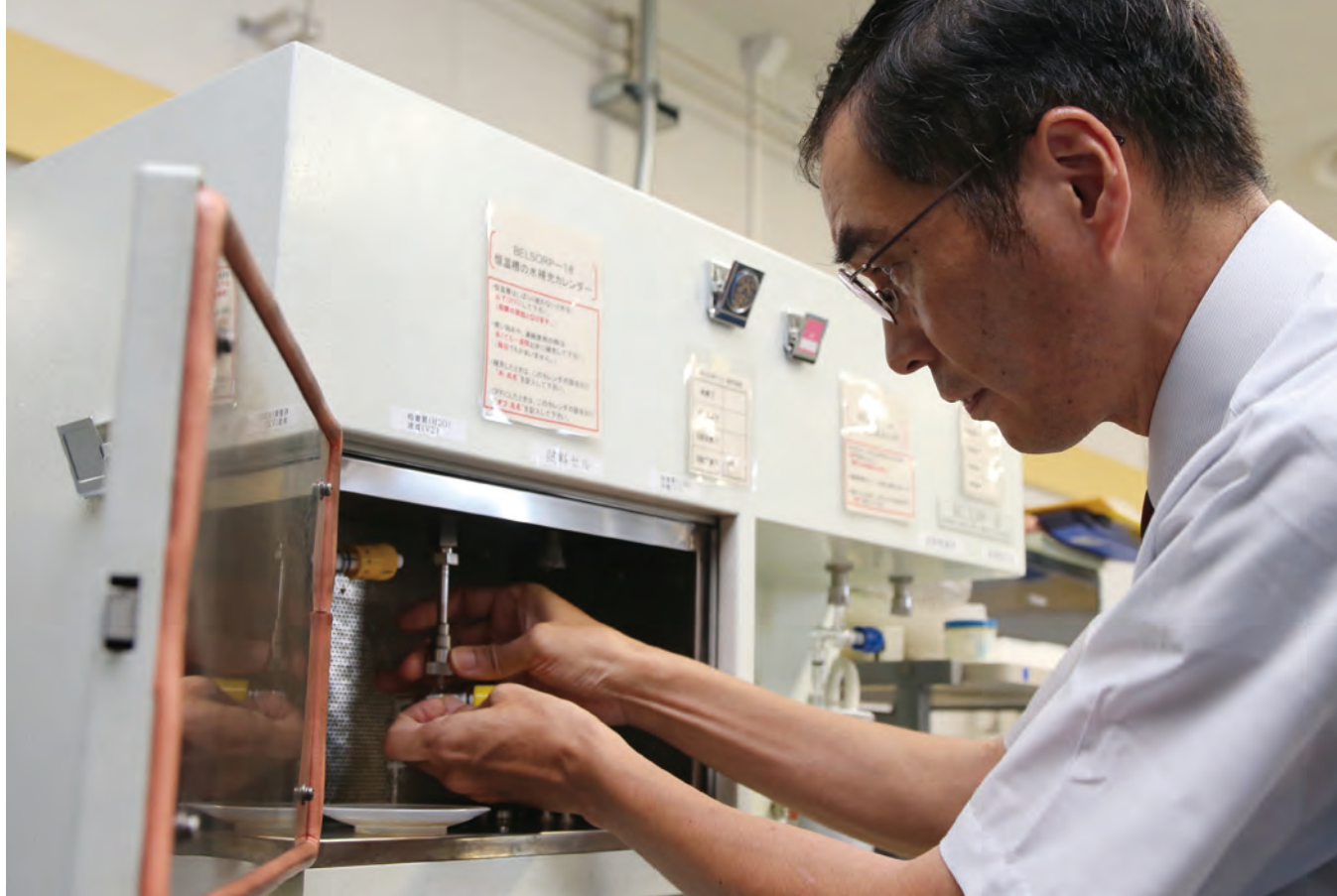
▲ナノ多孔質セラミックスの吸湿性を試験する自動測定装置。こうした装置がないと、試験だけで2〜3カ月かかることもある。
