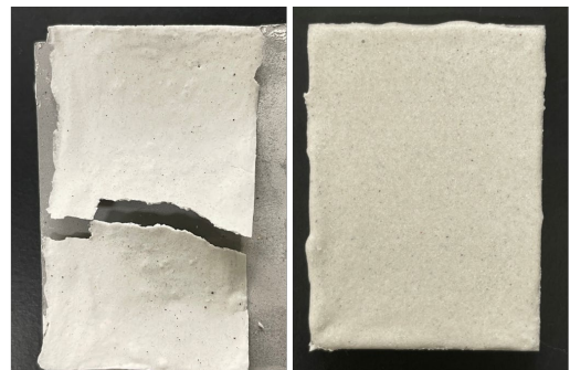
セルベンと高分子量ポリ乳酸の複合塗膜 セルベンとポリカプロラク톤の複合塗膜
