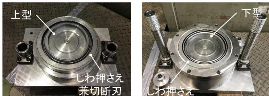
試作したペイント缶蓋用単発型プレス成形用金型
