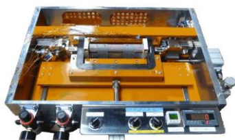
応力負荷型単板磁気試験器 【高精度磁気特性測定】
