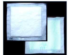
図 モデル吸収体の表と裏（10cm×10cmパルプ4g、高吸水性樹脂2gを混合し、ポリエチレンとポリオレフィン系（PE/PP）繊維の不織布で片面ずつ覆った）
