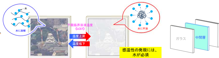
Fig. 3 温度応答性ポリマーを用いた合わせガラス
