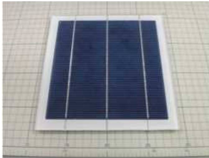
図 1. 開発した PID 対策太陽電池モジュールの外観写真
