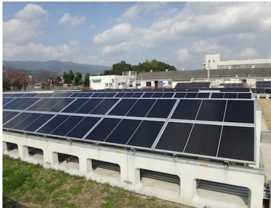
産総研の太陽電池モジュールの屋外曝露試験場と屋内環境試験機
