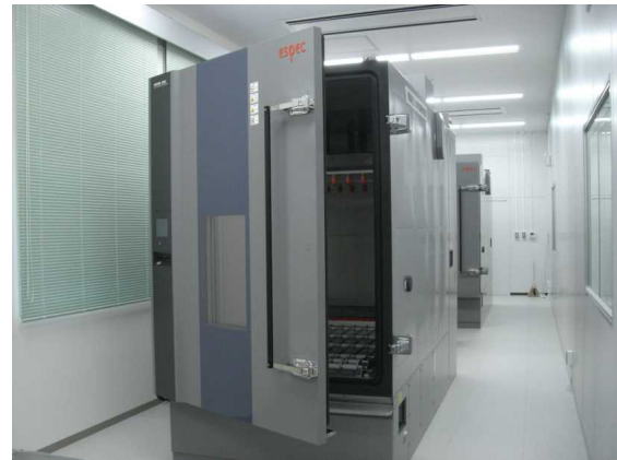
産総研の太陽電池モジュールの屋外曝露試験場と屋内環境試験機
