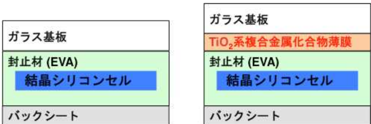
図 2. 標準型モジュール（左）と試作モジュール（右）の構造
