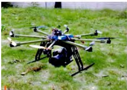
大型8枚羽式の機体 (80cm)
