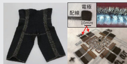
スマートテキスタイル技術 布上に印刷成形した歪みや圧力センサおよび導電系による配線や電極形成技術
