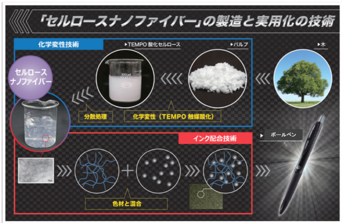
図 5.1.2.1.1 セルロースナノファイバー(CNF)の製造とインク配合技術の融合によるボールペンインク実用化
