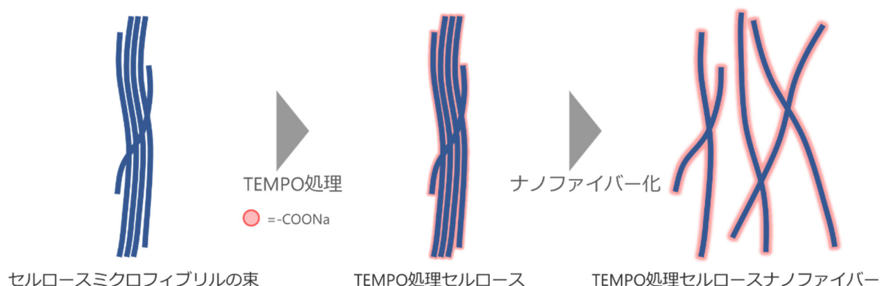
図 4.2.3.1.1 TEMPO 処理を用いたセルロースのナノファイバー化
