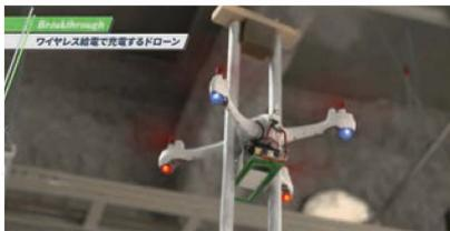
GaN-HEMT(GaN High Electron Mobility Transistor)が安全、大容量のワイヤレス給電を実現
