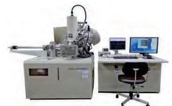
微小範囲かつ極表面の定性分析が可能なオージェ電子分光分析装置
