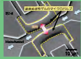
微細加工可能な温度応答性ゲルで製作したマイクロバルブ
