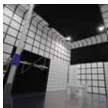
EMC試験を行う電波暗室
