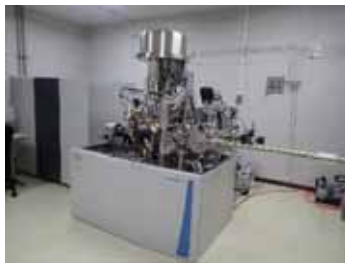
極表面複合分析装置 (極表面の原子の種類や数、 化学結合状態の分析)
