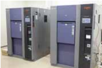
製品の急激な温度変化に対する耐性を評価できる冷熱環境試験機
