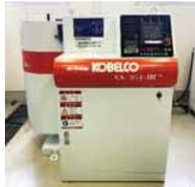
熱間等方加压装置 (等方的な圧縮加压と加熱処理)
