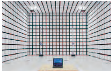
電磁環境規制に対応した10m法電波暗室
