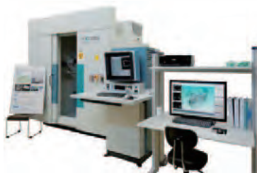
大型部品の非破壊検査を可能とする大型X線CT
