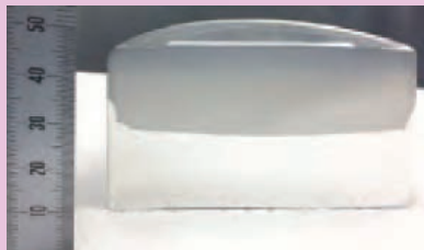
サーボプレスによる異種材料の接合
