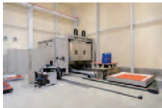
温湿度制御ができ、縦方向と横方向の加振ができる大型振動試験機
