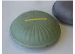
通気性セラミック型の開発 1983年から
