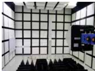
電子機器等からの電磁ノイズの強度・耐性を評価する エミッション測定システム イミュニティ試験システム
