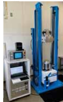
製品の衝撃耐久性など評価できる 落下衝撃試験機
