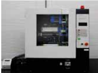
電気作用によってポリマーを超極細繊維化します エレクトロスピンニング装置
