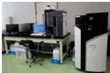
化成品などの合成中簡体に含まれる微量成分の定性・定量分析に活用できる 液体クロマトグラフ質量分析装置
