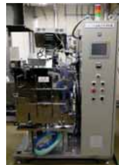
減圧マイクロ波乾燥装置(国補) (マイクロ波による食品の加熱・乾燥)
