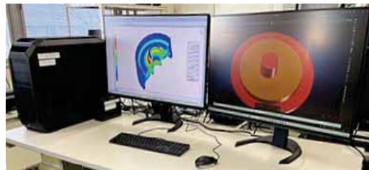
材料、部品、構造物などの様々な特性を有限要素法や分子動力学に基づく数値計算によりシミュレーションすることができる 統合型CAEシステム
