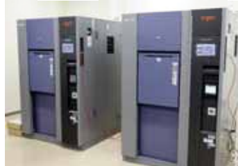
急激な温度変化に対する製品の耐性を評価できる 冷熱環境試験機
