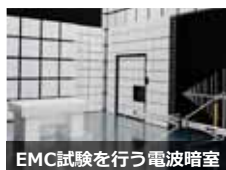
EMC試験を行う電波暗室
