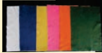
カチオン染料を用いたポリプロピレン繊維の新しい染色方法
