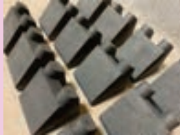
3Dプリンタにより作製した宇宙用蓄熱器
