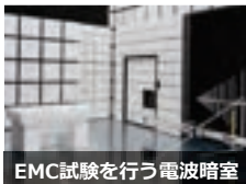
EMC試験を行う電波暗室
