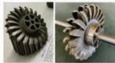
積層造形 仕上げ後 ペルトン水車翼
