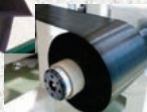
開織技術を用いた炭素繊維薄層プリプレグシート
