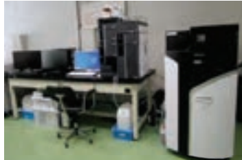
化成品などに含まれる微量成分の定性・定量分析に活用できる液体クロマトグラフ質量分析装置
