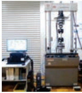
電気油圧サーボ疲労試験機 制御装置装置 (JKA補助) (引張-圧縮の繰り返しによる疲労試験)
