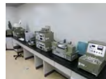
KES風合い計測システム
