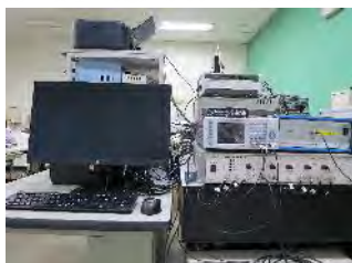
強誘電体材料の電気特性や変位特性を測定する強誘電体テストシステム
