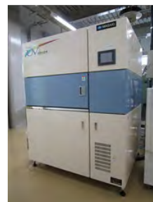
強力な紫外線で試料の劣化を促進させる超促進耐候性試験機
