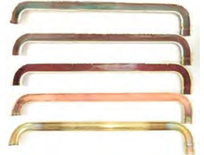
脱亜鉛試験後の水栓部品断面 (下：腐食無し、上へ：腐食逐増)
