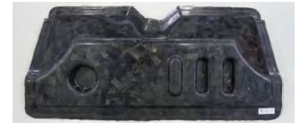
ファイアウォール部材（エンジンルームと運転席の仕切りパネル）
