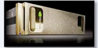
大量のデータを使用する 学習計算を高速に行い、 クラウドでの使用可能な AI学習用並列処理コンピュータ
