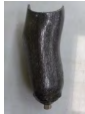
熱可塑性CFRPを用いた義肢
