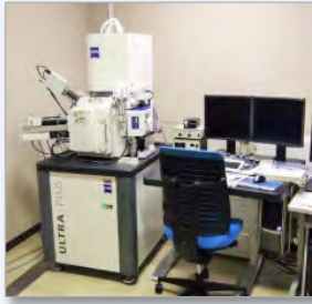
ボロン(B)のX線分析、 結晶方位観察可能な 高分解能電子顕微鏡システム
