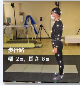
歩行路 幅 2m、長さ 8m 動作計測や関節角度計測可能な 人体動作解析装置、生体安全評価装置
