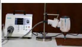
静電気試験器 ESS-B3011A (ノイズ研究所製)
