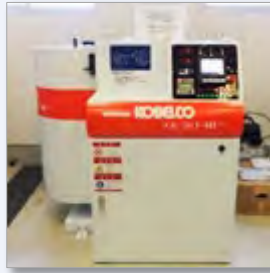
等方的な圧縮加圧と 加熱処理を行う 熱間等方加圧装置
