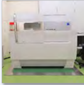
製品内部の高精度計測可能な 計測用X線CT装置
