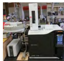
有機物質やガスの定性分析、定量分析ができるガスクロマトグラフ
