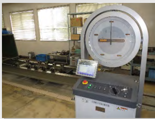
ロープ引張試験機(100kN)
