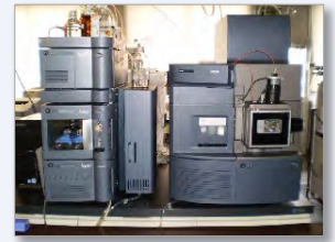
ポリフェノールなど機能性成分の定 量・定性分析を行う 液体クロマト グラフ飛行時間型質量分析計
