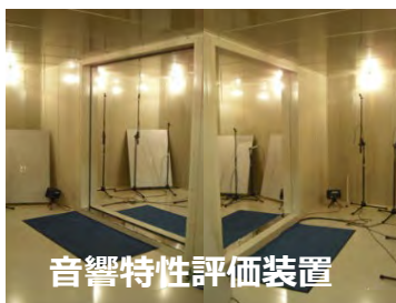
ダブルチャンバー式環境試験室
