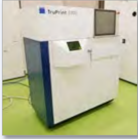
金属粉末を製造するアトミス装置 パウダーベッド方式の金属積層造形装置
