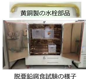
脱亜鉛腐食試験の様子
