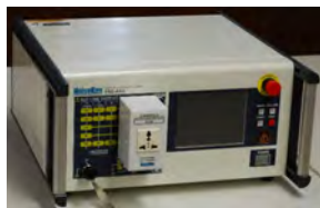
ファストトランジェント・バースト試験装置 FNS-AX4-B63 (ノイズ研究所製)
