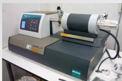
高精度熱膨張計
