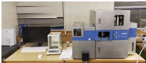
金属材料に含まれる炭素と硫黄の成分量を定量分析する炭素硫黄分析装置
