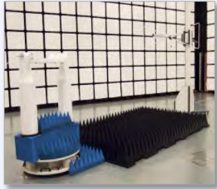
電磁波ノイズ試験、 アンテナ特性評価のための 電波暗室、電磁波評価システム
