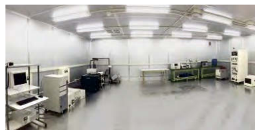
小型自動車が入室できる電磁環境負荷試験室
