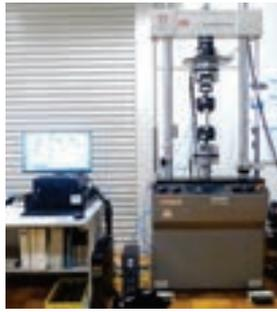
**電気油圧サーボ疲労試験機
