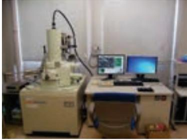
FE型走査電子顕微鏡EDX付
