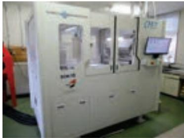
砂型積層造形装置
