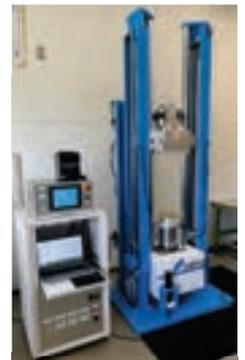
製品の衝撃耐久性など評価できる落下衝撃試験機
